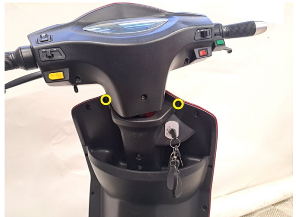
Irrota etupaneelin kiinnitysruuvit. (ristipäämeisseli ph2).
