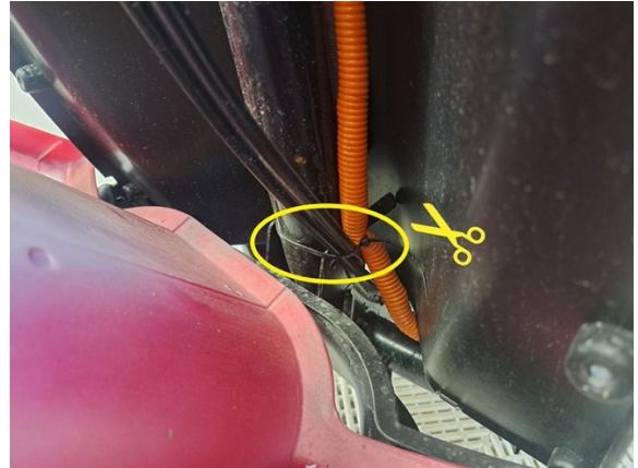
Katkaise johtosarjaa kiinni pitävät nippusiteet. (sivuleikkurit).
