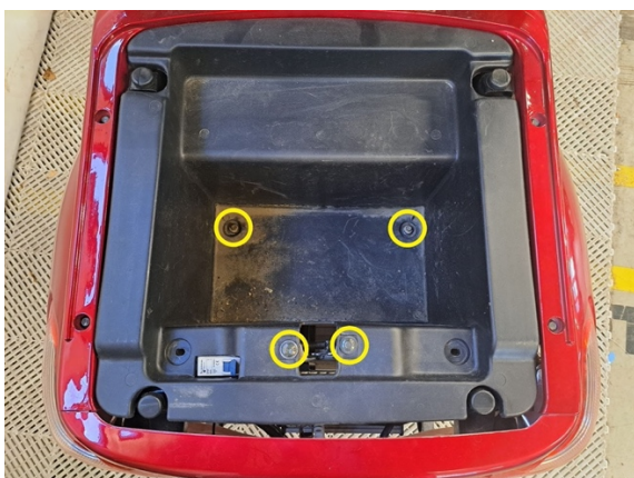
Irrota säilytyslokeron kiinnityspultit. (hylsy 8 mm).
