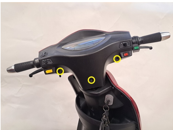
Irrota valomaskin ja mittarin kehyksen kiinnitysruuvit (ristipäämeisseli ph2) ja kiinnityspultti. (hylsy 8 mm).
