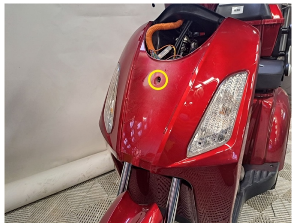
Irrota etukatteen kiinnityspultti. (hylsy 8 mm).
