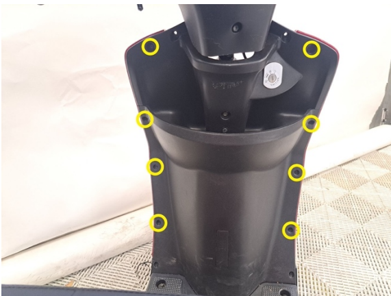
Irrota etukatteen kiinnitysruuvit. (ristipäämeisseli ph2).
